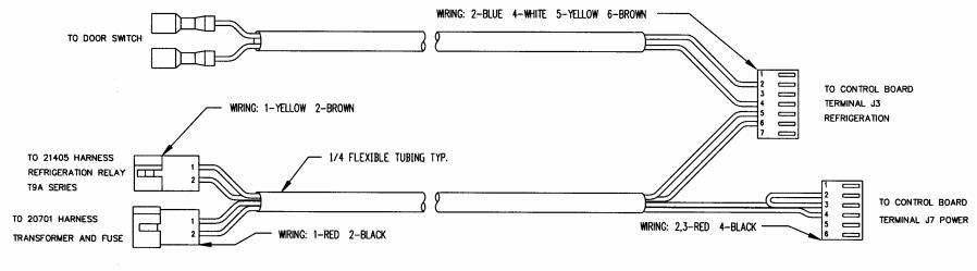
21591, HARNESS, CONTROL POWER AND REFRIGERATION RELAY, LEFT SIDE DOOR SWITCH, SENSIT II
